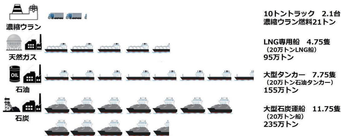
図 2-8 100 万 kW の発電設備を 1 年間運転するために必要な燃料
