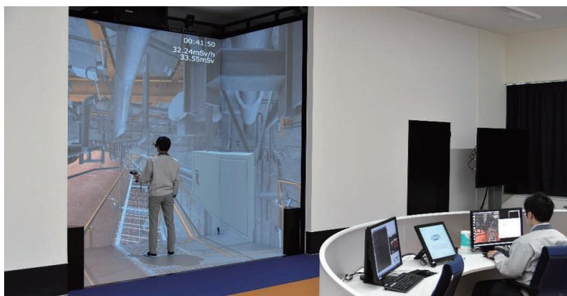
図 6-8 檜葉遠隔技術開発センターにおける VR システムによる東電福島第一原発原子炉建屋内のシミュレーション
