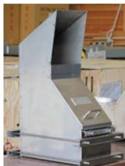
静的触媒式水素再結合装置
