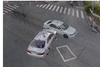
3Dレーザースキャナによる三次元画像
